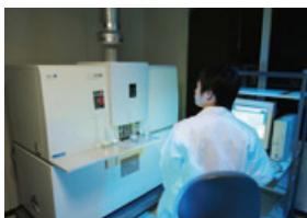
禁止物質の精密分析を可能とする誘導結合プラズマ発光分光分析装置(ICP-AES)
