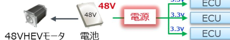
**電源ICには、高い入力電圧に対して低い電圧を出力することが求められる**
