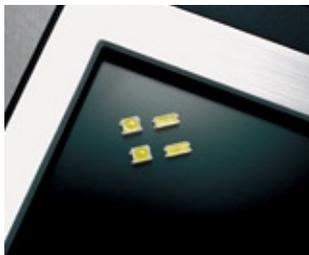
ロームが開発した白色LED「PSML1/PSML2」は、中電流域では世界最高クラスの光度7cd(100mA時)を達成。また、熱伝導率の高いCuフレームを採用し、パッケージの裏面にフレームを露出することにより基板への放熱経路を増やし、放熱性も大幅に改善しました。その為、一般的な耐熱性を持つFR-4基板(ガラス基材エポキシ樹脂積層基板)実装時でもPSML1で70°C/W、PSML2で60°C/Wの高い放熱性を実現しています。また、構造の改善により温度依存性の問題を解消、中電流域での光度劣化・色調変化を低減し、更には長寿命化や温度の高い環境にも対応できます。
