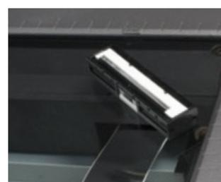
ロームのCISは、自社製LED光源、センサチップ、及び、効率的な工学設計により大きな温度変化や連続使用時でも安定した読み取りを実現した高性能ヘッドです。光学技術を駆使した独自開発プリズムは、光源からの光を、読み取り領域に均等に照射し、光量の損失を最大限におさえています。光源にはR,G,BのLEDを採用しておりカラー読み取りに対応。冷陰極管を使用しないため、CCD方式に比べて、光量が安定しており長寿命です。また、電源電圧3.3Vの低電圧動作により、セットの省エネに貢献します。
