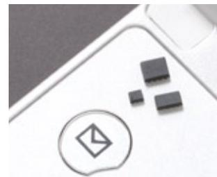
今回ロームが開発したECOMOS™シリーズは、独自に開発した低電圧動作プロセスの採用により $V_{GS}=1.5V$ の低電圧領域での安定動作を実現。また、1.5V動作時のON抵抗は、従来を大きく下回る大幅な低ロス動作を実現しました。このことにより、ON状態の消費電力を20~85%低減し、デジタルスチルカメラや携帯電話、ポータブルオーディオなどの小型携帯機器の省エネ化に貢献します。
