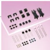
フォトインタラプタは、小型化するメカトロニクス機器の中で、回転機器の回転数検出、カードなどの位置/サイズ、移動、遮断/開閉/通貨、方向、圧力など、あらゆる動きの検出にますます重要性を増しています。ロームのフォトインタラプタは、固有の化合物半導体技術で開発した赤外発光ダイオードとフォトトランジスタを独自のパッケージ技術で一体化させた技術の結晶です。その技術力が、業界最小の面実装フォトインタラプタを生み出しました。小型化するカメラや携帯電話の光学系などの極小部位に使用されています。ロームは、このフォトインタラプタに加え、発光素子と受光素子を並べた反射型のフォトリフレクタやデジカメの縦横を判定する4方向センサなど、あらゆる検出ニーズに対応できる製品をラインアップしセンサ市場のニーズに対応してまいります。
